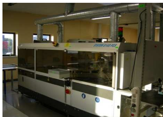
« La vague », où les composants sont soudés par bains d'étain
