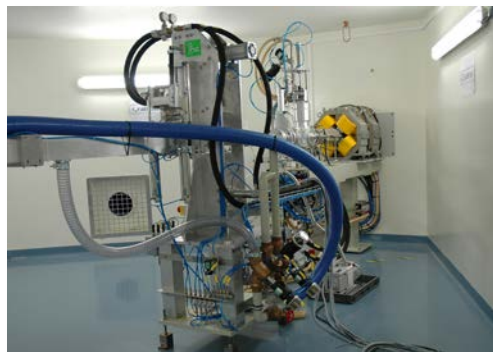
Station d'irradiation pour production de Sr82
