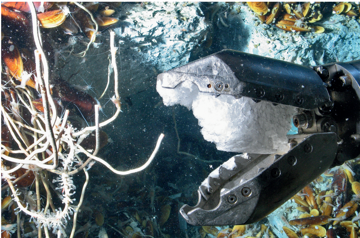
Une «bouchée» d'hydrate de gaz au bout du bras du robot Victor 6000.
